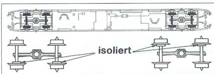
Radsätze müssen mit ihren grauen Isolierbüchsen entsprechend Abbildung eingesetzt sein (Kurzschlußgefahr).
