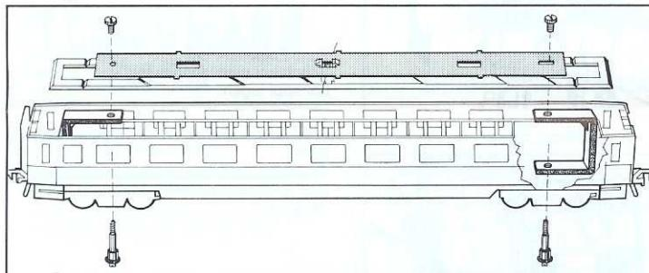
Lichtleiter mit Aussparung auf Bügel in Wagenkasten legen und festschrauben (Leiterplatte muß zum Dach zeigen).
