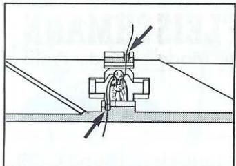
Glühlampe so in die mittlere Aussparung des Lichtleiters legen, daß die Drahtenden in den v-förmigen seitlichen Kerben liegen.
