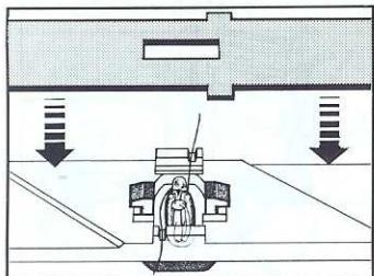
Leiterplatte mit der metallisch glänzenden Leiterbahn zum Lichtleiter hin auf die Halteklemmer aufstecken. Anschlußdrähte müssen in den v-förmigen Kerben liegen bleiben.
