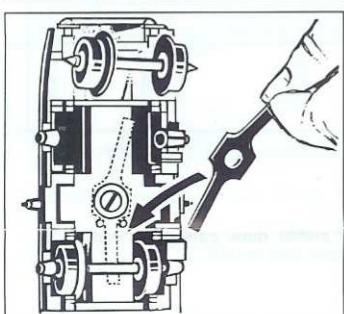
Zum Einsetzen der Stromabnehmerfeder Schraube **nicht** lösen; nur über Schraubkopf legen.
