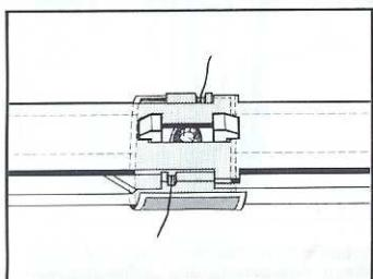
Zuerst Metallfolie, dann weiße Isolierfolie wie gezeigt über Lichtleiter und Halteklemmer kleben (vorher Schuttpapier vom Kleber entfernen).
